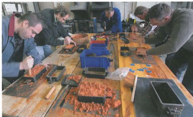
Die Teilnehmer am Pilotkurs in Ochsenhausen-Reinstetten beim Einformen des Formsandes
