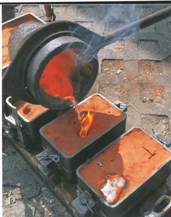
...geschmolzen, wird es aus dem Tiegel in die Formkästen gegossen
