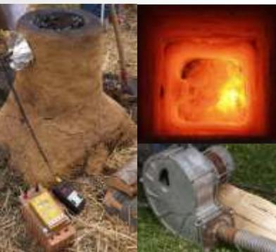
Bis zur Entwicklung der Hochöfen im späten Mittelalter wurde Eisen in Rennfeueröfen oder Rennherden hergestellt. In diesen liegen die Temperaturen nur bei etwa 1200 - 1300 °C. Es kommt daher im Rennfeuer zu keiner Schmelzung des Eisens, sondern die im Eisenerz enthaltenen Gesteinsreste werden bei diesen Temperaturen flüssig und „rinnen“ (daher der Name!) in den unteren Bereich des Ofens.
