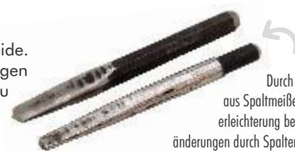
Durch aufeinander abgestimmte Paare aus Spaltmeißel und Runddorn ist eine Arbeitserleichterung beim Lochen möglich. Die Längenänderungen durch Spalten und Dornen kompensieren sich und die Längen im Werkstück bleiben erhalten. So lassen sich Lochungen schnell und präzise herstellen. Für Lochungen von 10-20 mm verfügbar.
