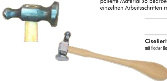
Beim Ciselieren werden glatte Metalloberflächen spanlos verformt. Mit Hilfe von Ciselierhämmern und verschiedenen Werkzeugen (Punzen, Stichel, Meißel) wird das kalte, meist polierte Material so bearbeitet, dass reliefartige Verzierungen entstehen. Zwischen den einzelnen Arbeitsschritten muss das Metall immer wieder erhitzt werden, um es zu entspannen.
