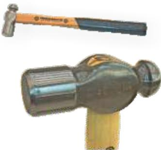
Die englische Form des Schlosserhammers wird auch Ingenieurhammer genannt. Dieser Name entstand allerdings aus einer falschen Übersetzung des englischen Begriffs "engineer", welcher in diesem Zusammenhang eigentlich für Mechaniker oder Maschinist steht.
