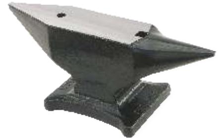
**NORDDEUTSCHE FORM** → aus legiertem Stahlguss, Bahn gehärtet und geschliffen, mit einem Rundhorn und einem Rechteckhorn, mit Vierkantloch ca. 25 x 25 mm für Gesenke und Rundloch ca. ø 22 mm.
