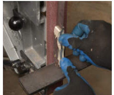
Kaum eine Maschine erleichtert dem Messermacher die Arbeit so sehr wie ein stationärer Bandschleifer.
