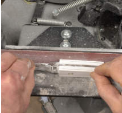
Der Radiusmaster leistet 1.500 Watt. Bei der Bearbeitung von Griffmaterial ist daher Vorsicht geboten – besonders mit groben Bändern –, da der Materialabtrag sehr hoch ist.
