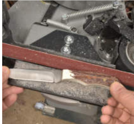
Auch das Konturieren von Griffen wird einfacher, wenn die verwendete Maschine viele verschiedene Führungen und Schleifflächen aufweist.
